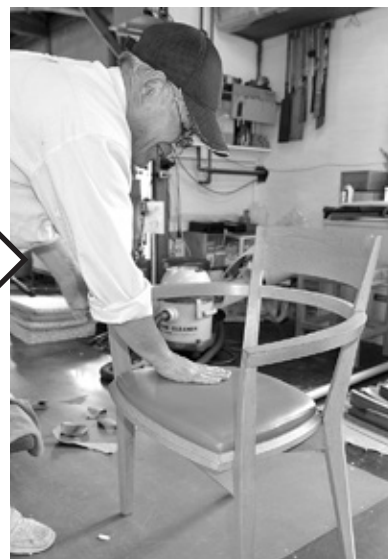
④ベニヤ板の裏側に布を張り、本体にねじ止めて完成。美しく、しっかりと修理するには、確かな技術を持った職人による手作業が必要なのです。
