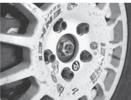
独自の形状により安定したゆるみ止め性能を発揮するボルト・ナット・座金
